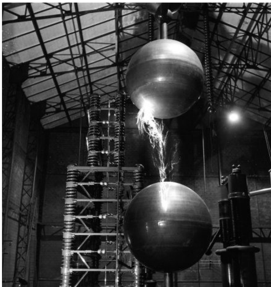
DOISNEAU Robert, L'éclateur à sphères du Laboratoire de synthèse atomique , Ivry, photographie, 1957, ©www.robert-doisneau.com
