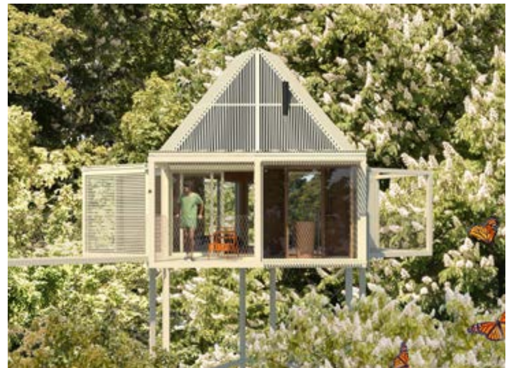
Cabanes pour promotion d'un tourisme lent - structure bois et isolation chanvre - Vibrac (16) - concours (YAC) - 2020
