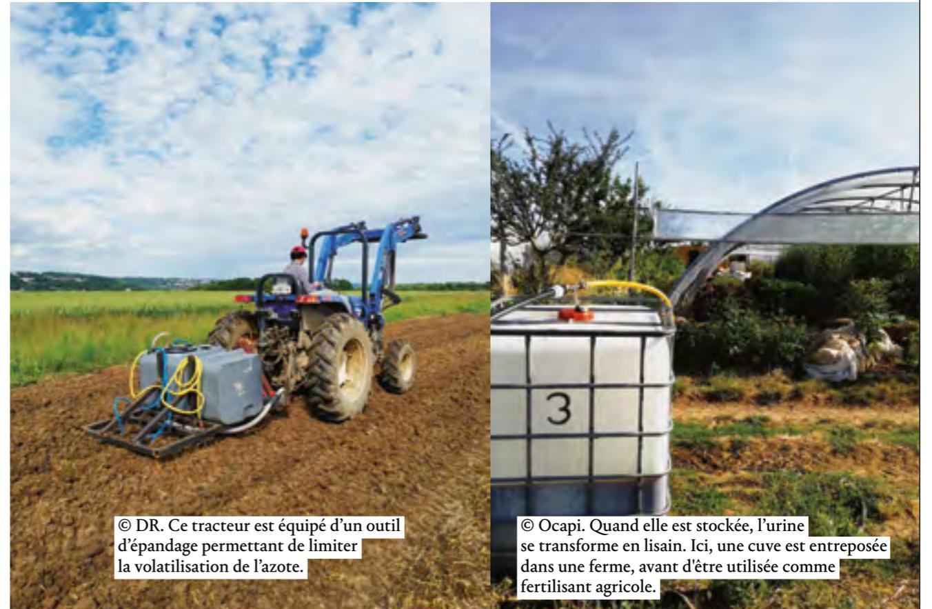
© DR. Ce tracteur est équipé d'un outil d'épandage permettant de limiter la volatilisation de l'azote.
